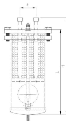
SECTIONAL OIL SEPARATORS FOR R410A / SEPARADORES DE ACEITE DESMONTABLES PARA R410A
